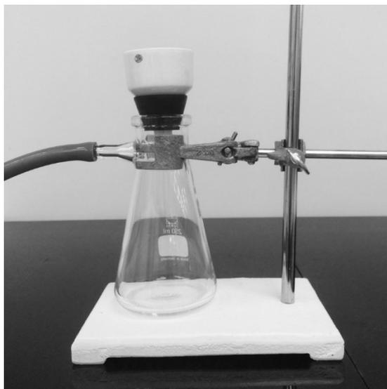
**Figura 2:** Montagem do sistema de filtração à vácuo.
