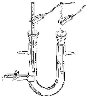
Uma solução de KI é posta no tubo em U até atingir, aproximadamente,  $\frac{3}{4}$  de seu volume. Após ligar a fonte de corrente contínua, observa-se a ocorrência da eletrólise durante 15 minutos. No eletrodo onde bolhas de gás são formadas, colocam-se 4 (quatro) gotas de fenolftaleína.
