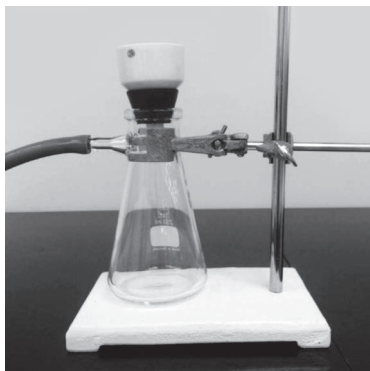
Figura 2: Montagem do sistema de filtração à vácuo.
